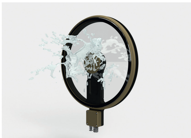
2 Dank Labyrinthkonstruktion und optionalem Überdruck sind die Spinvista sehr überspüldicht. Die Drehscheibe bremst innerhalb weniger Sekunden auf eine nichtkritische Drehzahl © Hema
